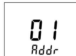
Menu de réglage de l'adresse Modbus (en alternance)
