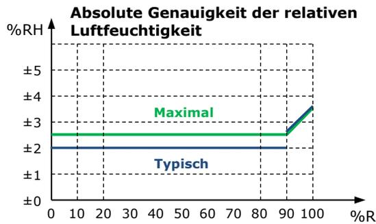
Abbildung 1: Typische und maximale RH-Genauigkeit bei 25°C (77°F)
