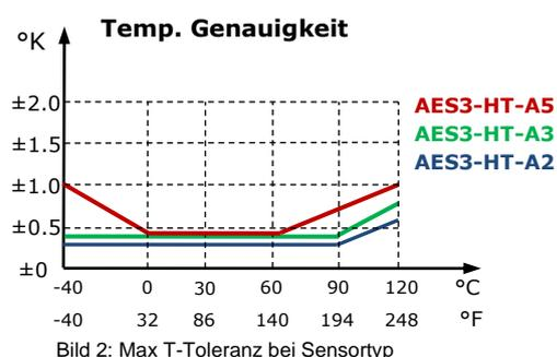
Hinweis zur Genauigkeit: Diese wird nach einer Stunde nach Einschalten der Stromzufuhr erreicht (einpendeln der internen Kompensation).
