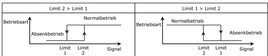
**Automatisches Ein/Ausschalten des Reglers über Steuersignale oder Alarmzustände**
